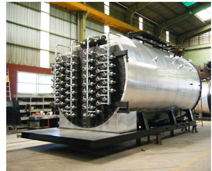
Sistema de soplado limpieza de tubos.
