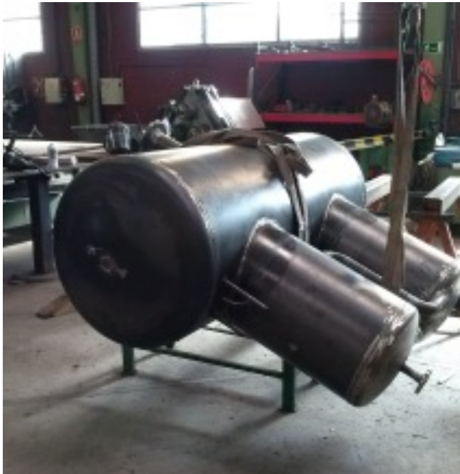
Equipo de expansión de aceite térmico fabricación.
