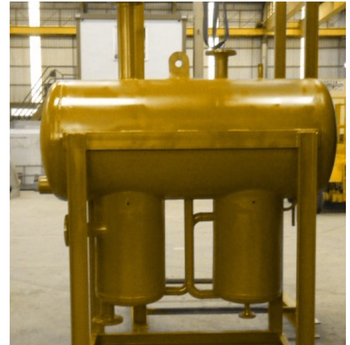
Equipo de expansión de aceite térmico instalación.
