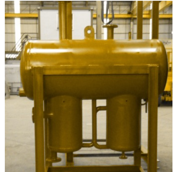
Equipo de expansión de aceite térmico instalación.
