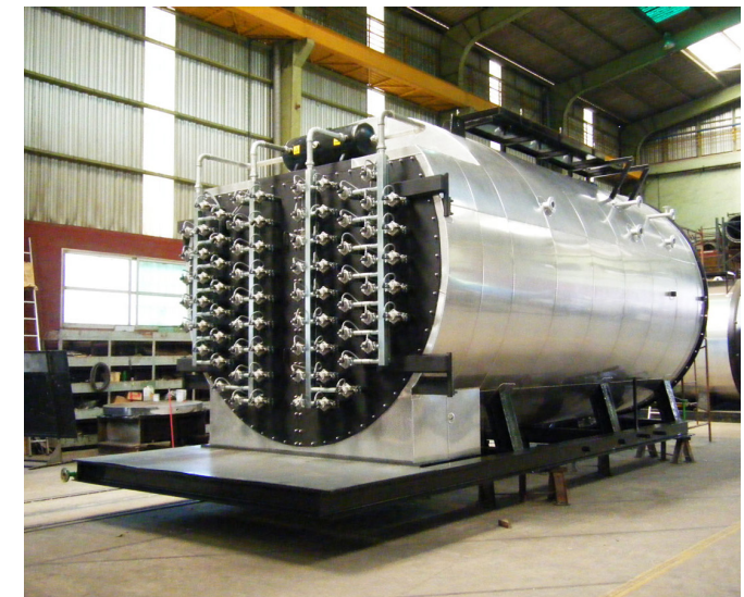
Sistema de soplado limpieza de tubos.
