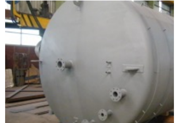
Deposito industrial en fabricación.
